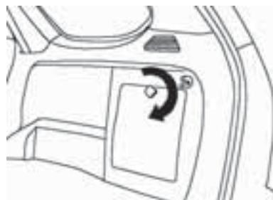
Нажмите и поверните ручку бокового ящика в багажном отсеке, чтобы открыть его. Внутри него находится знак аварийной остановки, домкрат, набор инструментов и задний омыватель. Нажмите и поверните ручку, чтобы закрыть, как показано на рисунке.
