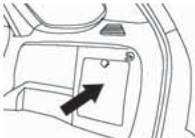
В багажнике в ближней части боковой панели находятся инструменты и домкрат, ручка домкрата находится внутри ящика с инструментами.
