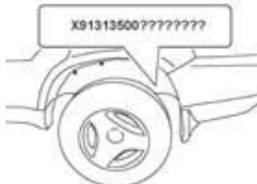
Идентификационный номер указан на внешней стороне левого лонжерона рамы автомобиля.
