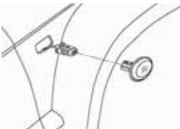
① Нажмите изнутри защелку бокового указателя поворотов чтобы снять его. Отсоедините его от пучка проводов (не опустите пучок проводов обратно через отверстие).
