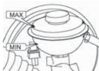
**Проверка тормозной жидкости**
