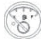
При включении зажигания, этот указатель покажет уровень топлива в топливном баке:
