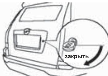
Жмите на заднюю дверь, пока она не закроется. Вставьте ключ, поверните его по часовой стрелке, чтобы закрыть дверь. Убедитесь, что дверь надежно закрыта, иначе она может открыться во время движения, может выпасть багаж, либо выхлопные газы могут попасть внутрь автомобиля.
