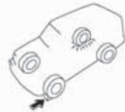
Заблокируйте колеса по диагонали от спущившей шины. Передние колеса подоприте спереди, задние – сзади.
