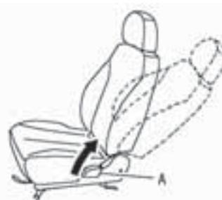
Потяните рычаг регулировки, отклонитесь назад и установите спинку в нужное положение. Отпустите рычаг, спинка останется в этом положении.
