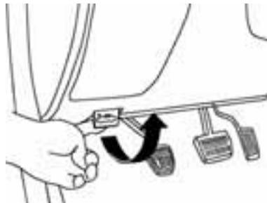
① Потяните ручку открывания капота под панелью приборов со стороны водителя, капот приоткроется.
