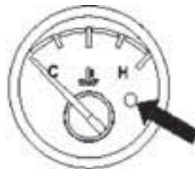
Предупредительная лампа температуры охлаждающей жидкости находится под отметкой «Н» на указателе температуры.
