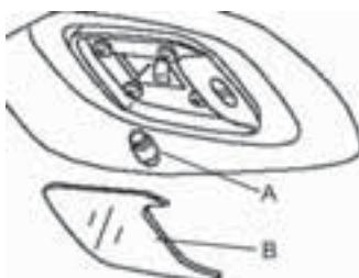
Используя отвертку вытащите крышку В, затем замените лампу А.
