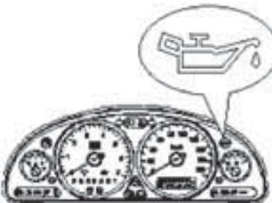
Лампа находится выше указателя топлива. Включите зажигание, лампа загорится. Она должна погаснуть после запуска двигателя. Если она продолжает гореть, это указывает на слишком низкое давление масла. Немедленно заглушите двигатель и проверьте уровень масла. Если лампа горит при нормальном уровне масла, свяжитесь со специализированной сервисной станцией.
