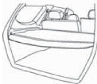
Полка багажника находится позади второго ряда сидений и используется для накрывания багажного отсека, что придает более ухоженный вид багажному отделению, и сокращает его объем для более быстрого охлаждения при работающем кондиционере.
