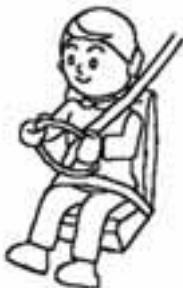
Регулировать длину ремня нет необходимости. Он автоматически регулируется под ваш размер и положение на сиденье. Он удерживает вас при резкой остановке или ударе.
