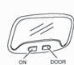
В автомобиле два плафона (один спереди, второй сзади), которые включаются кнопкой.
