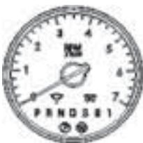
При движении наблюдайте за тахометром, который показывает частоту вращения вала двигателя ( $\times 1000$  об). Он помогает водить автомобиль в более экономном режиме и не допускать превышения оборотов двигателя.
